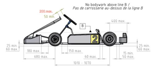
La distance maximale entre le bord supérieur central du panneau avant et le bord du volant en son point central ne doit pas dépasser 200 mm.
